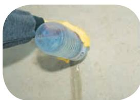
Zkouškou nasákovosti na několika místech zjistit stupeň a rovnomořnost nasákovosti původního podkladu. Voda musí pomalu a rovnomořně vyschnout.
