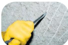
Přezkoušet pevnost omítky vrypem šroubováku do povrchové vrstvy omítky.
